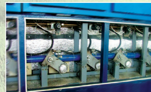
A padlózati szegmens hidraulikus meghajtása
